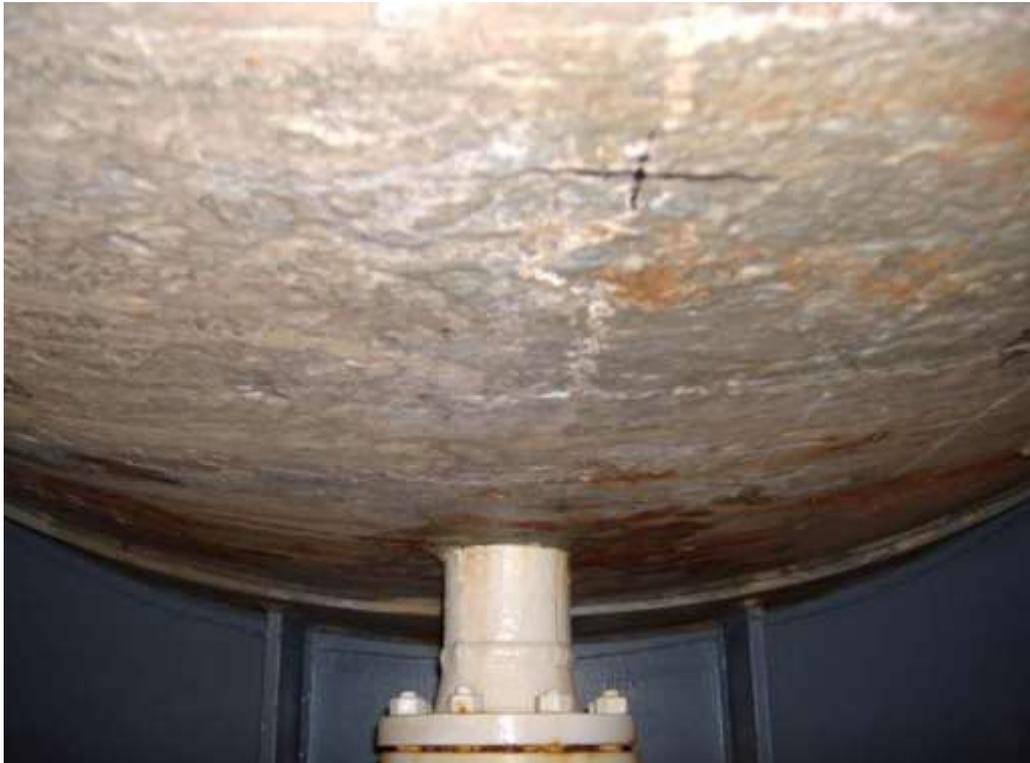
**Figura 10.4.5 – Áreas corroídas / superfície rugosa prejudicando a inspeção CHIME**
